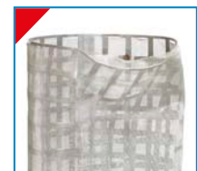
Figuras 1 y 2. Mallas colapsadas por elevada presión diferencial.
